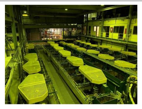
Figure 18-37: Flotation Circuit
